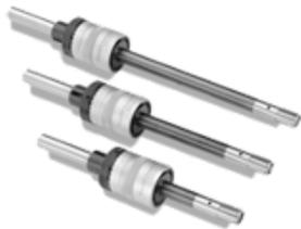
**Innenrollierwerkzeuge** eignen sich für die Bearbeitung von Bohrungen im Durchmesserbereich 4mm – 177mm. Die Werkzeuge sind in Schritten von 0,0025mm einstellbar. Die erforderliche Walzkraft wird erzeugt, indem das Werkzeug 0,01-0,02mm größer als der zu bearbeitende Durchmesser eingestellt wird.
